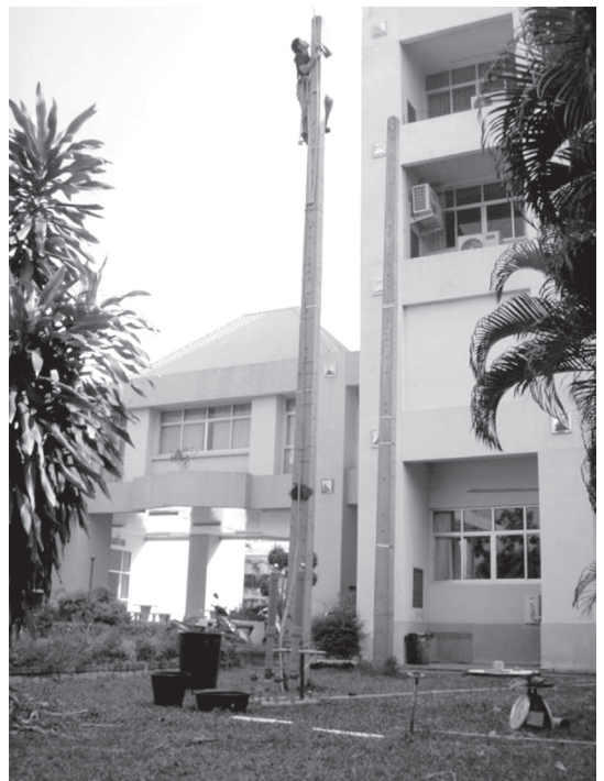
รูปที่ 2 การติดตั้งชุดทดสอบปริมาณน้ำที่ส่งขึ้นไปได้
