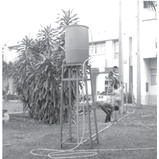
รูปที่ 1 ชุดทดสอบตะบันน้ำ
