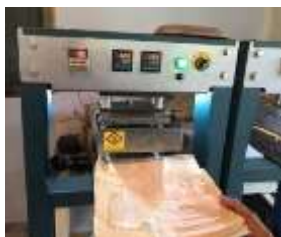
รูปที่ 6-8 การนำเปลือกข้าวโพดเป็นแผ่นสี่เหลี่ยมจัตุรัสเข้าเครื่องขึ้นรูปภาชนะ (ภาพถ่ายโดยผู้วิจัย)
