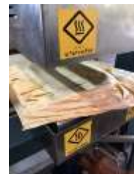
รูปที่ 6-8 การนำเปลือกข้าวโพดเป็นแผ่นสี่เหลี่ยมจัตุรัสเข้าเครื่องขึ้นรูปภาชนะ (ภาพถ่ายโดยผู้วิจัย)
